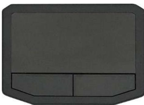
Сенсорная панель ноутбука является устройством ввода информации (заменяет компьютерную мышь). Позволяет управлять положением курсора на экране и производить функции выбора при помощи кнопок панели.
