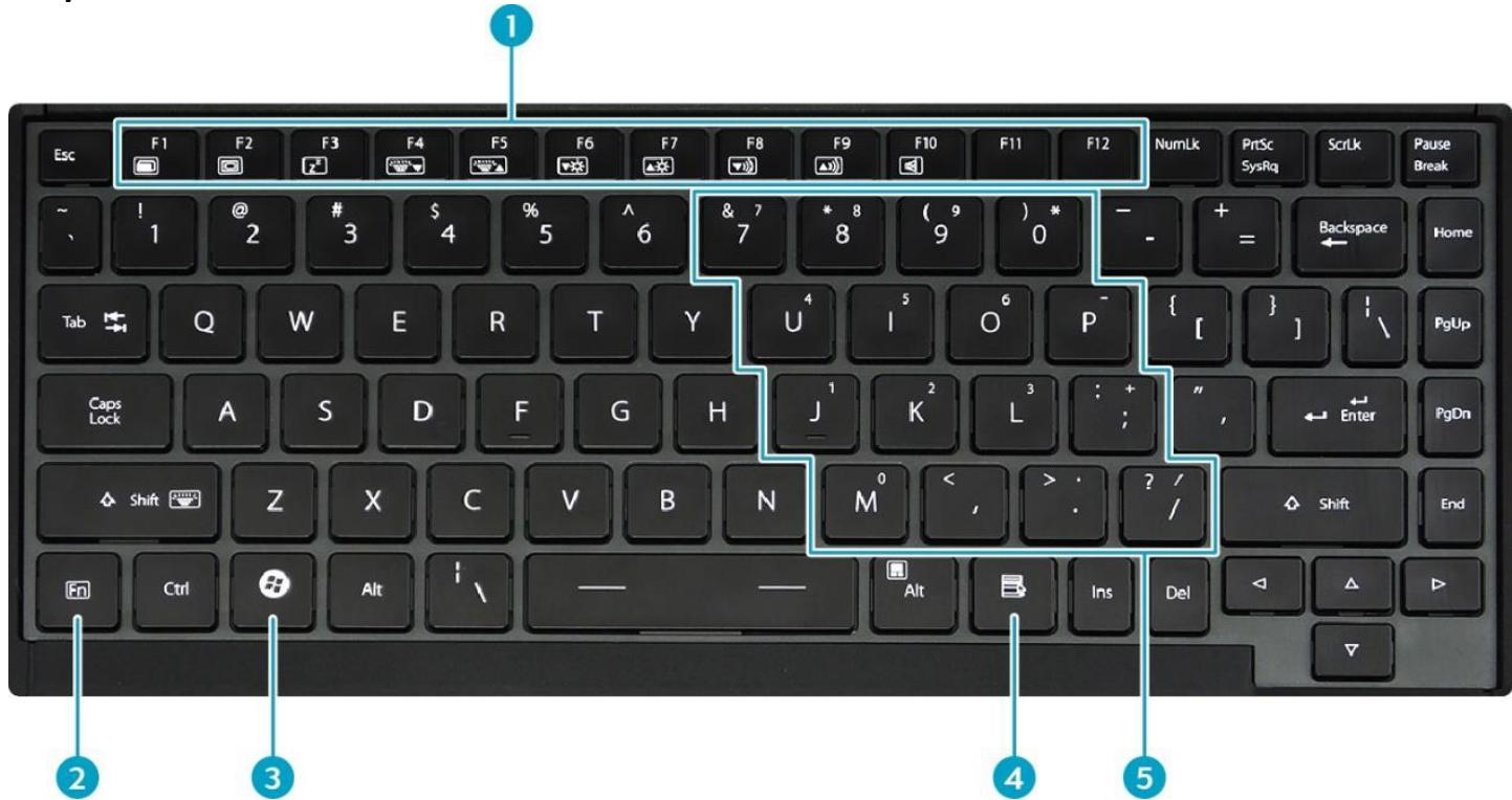
«Горячие» клавиши, являются комбинацией нескольких клавиш, при нажатии которых происходит активация или выбор функций. Вы можете с легкостью определить предназначение «горячих» клавиш, при помощи размещенных на них пиктограмм.
